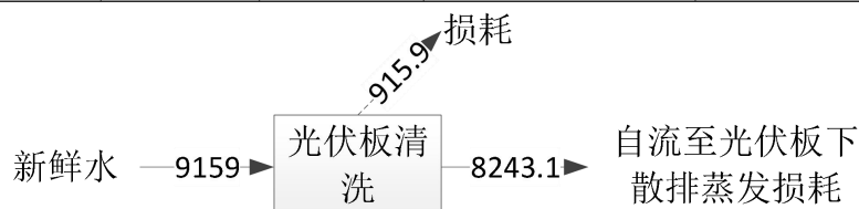
图 2-1 本项目水量平衡图单位：m 3 /a
