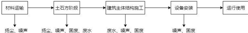
图 2-5 施工期工艺流程及产污环节图
