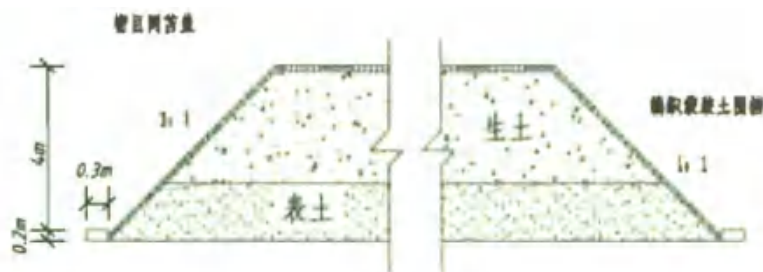
图2-9 井场表土临时堆存示意图
